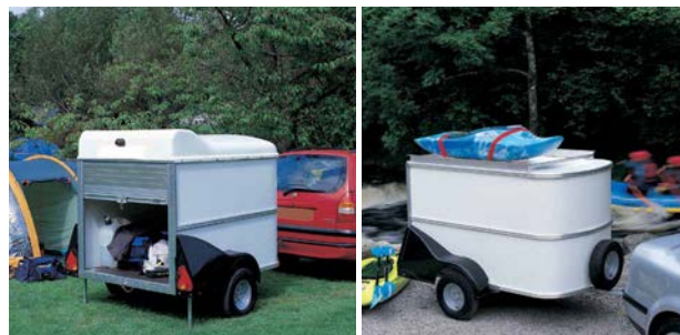
BV64e 6' x 4' x 4' Unbraked Box Van 500kg Gross Choice of roller shutter or van doors
